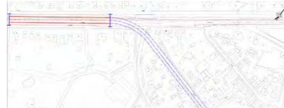
Indicatieve schets van de tunnel bij de Reeënlaan en Zwolseweg. Ondergronds deel van de tunnel (blauw) in de Reeënlaan, het open gedeelte aan de Zwolseweg (rood).
