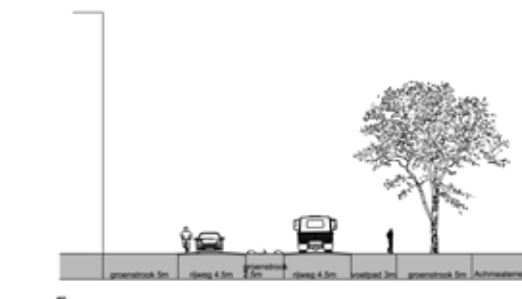
PROFIEL EE' Verbindingsweg met Achmea-terrein
