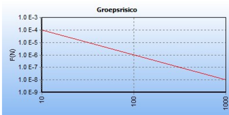
Figuur 5.1 FN curve voor 9075_leiding-N-559-07-deel-1 van N.V. Nederlandse Gasunie voor de kilometer tussen stationing 0.00 en stationing 1000.00
